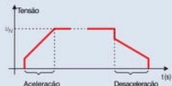
Permite a aceleração e/ou desaceleração suaves. Na aceleração ajusta-se também a tensão inicial. Na desaceleração ajusta-se o degrau inicial de tensão.
