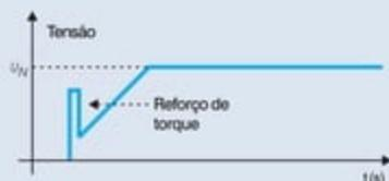
Permite um pulso inicial de tensão que aplicado ao motor proporciona um reforço de torque na partida, necessário
